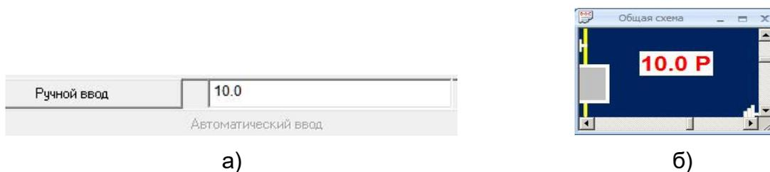
Рисунок 101 – Ручной ввод значения ТИ а) в паспорте б) на мнемосхеме
