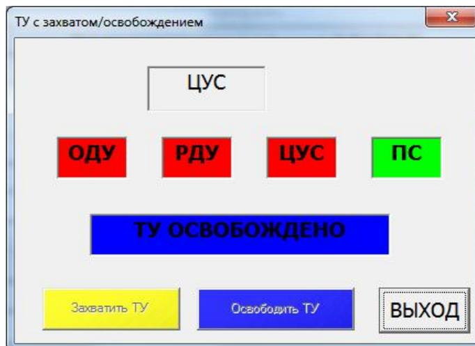
Рисунок 122 – Сигнализация о захвате ТУ в ПС
