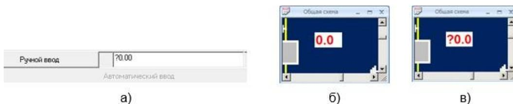
Рисунок 102 – Отображение значения ТИ при автоматическом вводе а) в паспорте, б) достоверного ТИ на мнемосхеме, в) недостоверного ТИ на мнемосхеме
