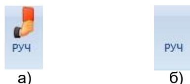
Рисунок 39 – Вид состояния командной кнопки «РУЧ»: а) имеются сигналы на ручном управлении, б) нет сигналов на ручном управлении
