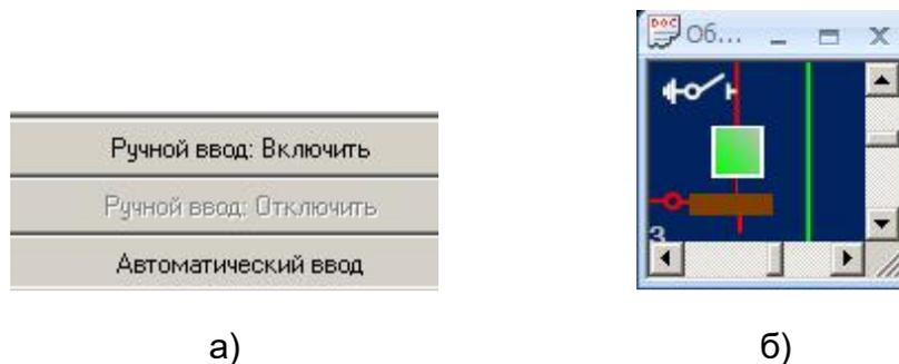
Рисунок 89 – Установка значения ТС «Отключено» в ручном режиме:
